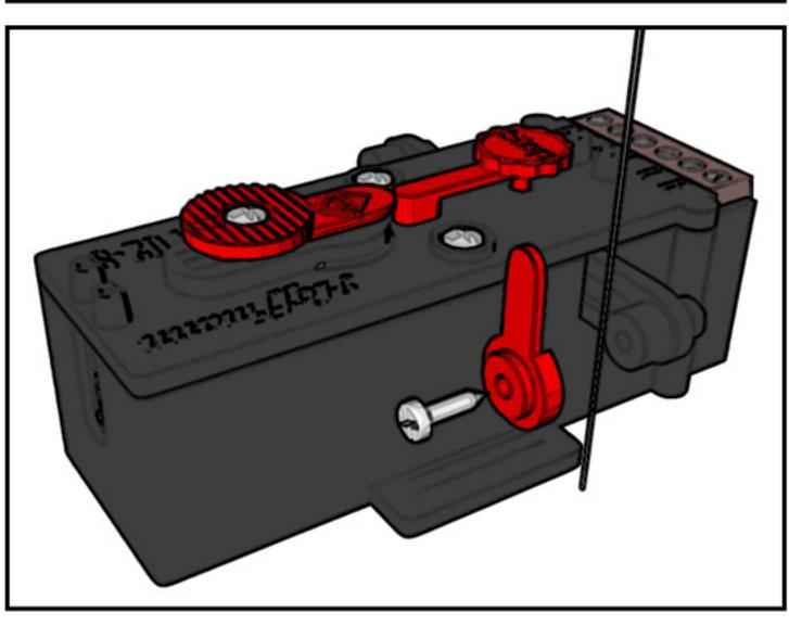
6. passenden Stelldraht auswählen und an die Stellstange schrauben
