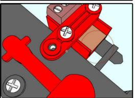
4. Wichtig: Mit der längeren Schraube aus dem Umbausatz befestigen
