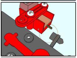
3. Beim Anbauen mus der Kontakthebel des Umschalters in die Bohrung der Stellstange eingreifen
